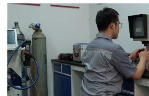
• 冲击试验缺口投影仪 Notch Projector for Impact Test
